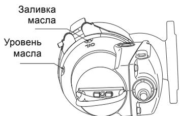
Рис. 17 Отверстия для заливки масла
