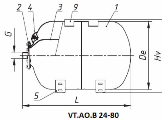
1 –корпус; 2 –контрфланец со штуцером подключения; 3- мембрана; 4-ниппель;5-стойки;6-держатель мембранны;7 – монтажные проушины; 8 – манометр; 9- площадка для крепления насоса.
