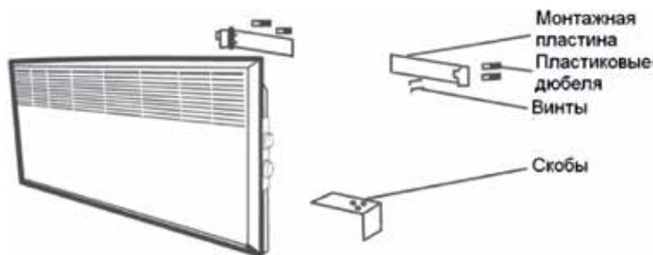
С помощью монтажного комплекта установите обогреватель на стене у пола. Расстояние от прибора до пола должно быть не менее 10 см.
